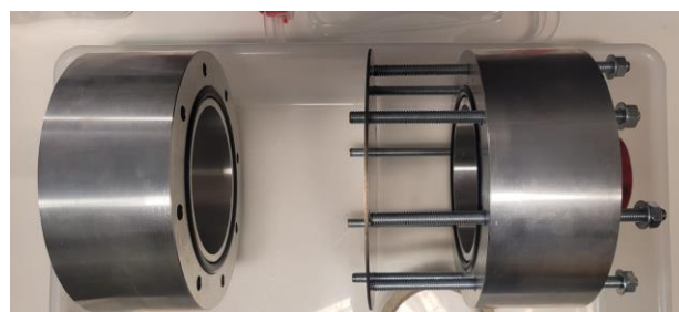
Figura 01 – Câmara de vácuo com membrana desmontada.
