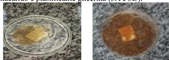
Figura 4 – Amostras de bioplásticos produzidos com macarrão e plastificante glicerina (3A e 3D).
