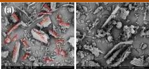
Figura 2: Micrografias da PS bruta a) 250x e b) 500x, no equipamento.
