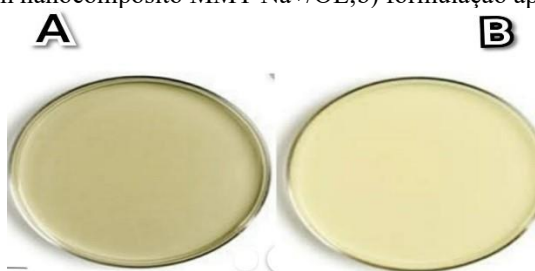
Figura 3: Resultado negativo para proliferação da análise microbiológica para E.Coli . a) formulação com nanocomposito MMT-Na+/OE; b) formulação apenas com OE.
