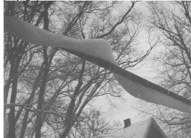
Figura 3: Kink de gelo, formado naturalmente pelo acúmulo de neve sobre uma barra horizontal [3]
