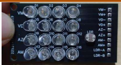
Figura 1. Matriz de LEDs usados como sensores
