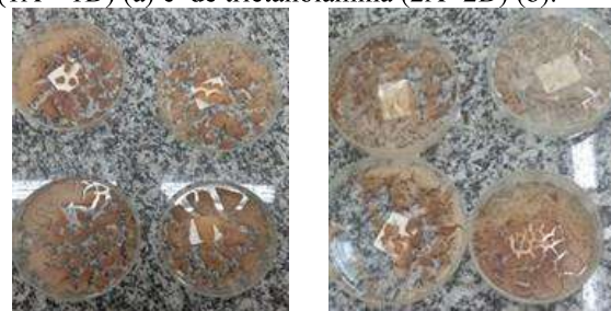
Figura 2 – Amostras de bioplásticos produzidos com amido de arroz e feijão e plastificantes de glicerina (1A – 1D) (a) e de trietanolamina (2A- 2D) (b).
