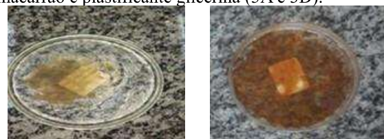
Figura 4 – Amostras de bioplásticos produzidos com macarrão e plastificante glicerina (3A e 3D).
