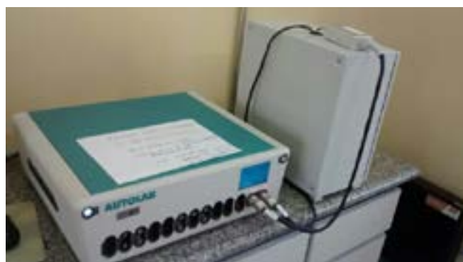
Figura 4. Potenciostato e gaiola de Faraday
