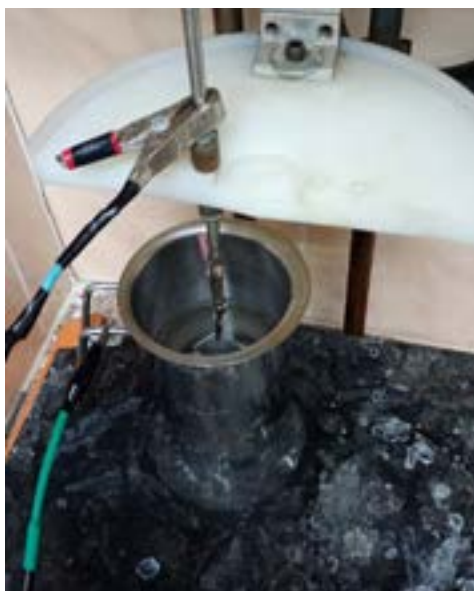
Figura 1 Reostato utilizado para aplicação do revestimento PEO
