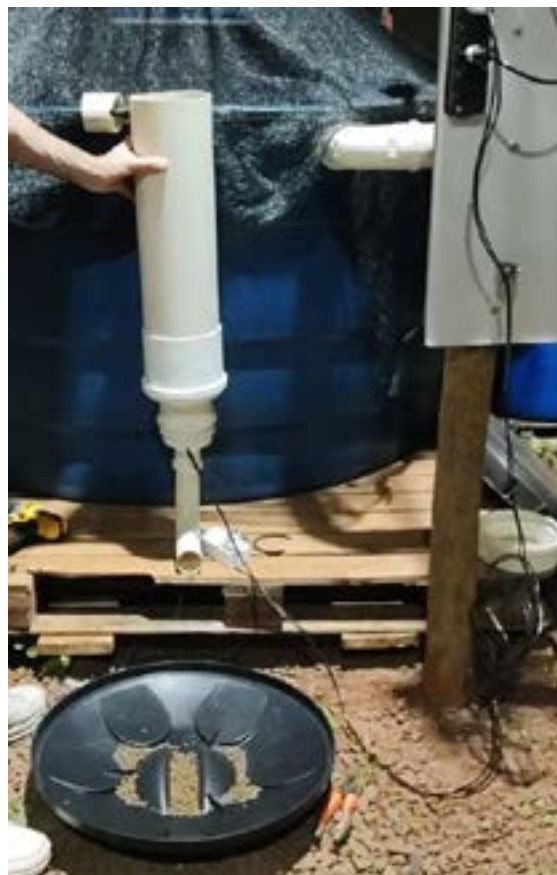
Figura 3 – Teste do alimentador para adequação de ração.
