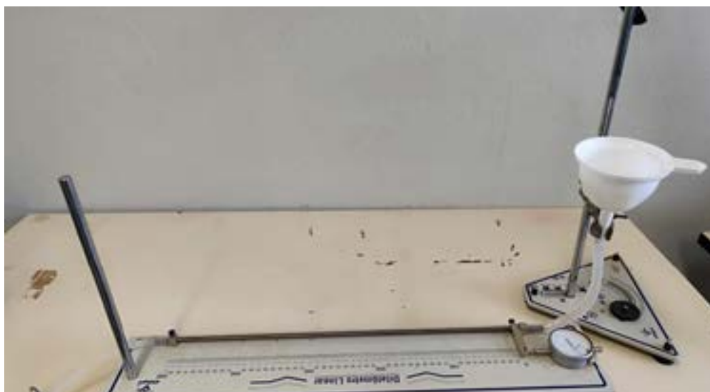
Figura 6 – Ensaio para a medida da expansão linear de tubos metálicos.
